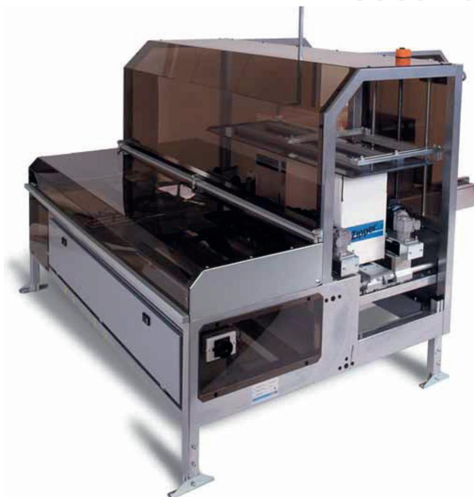
Magasin de caisses carton automatisé. Il peut se remplir durant le fonctionnement.
