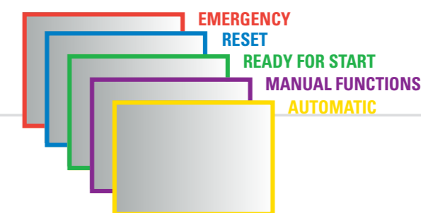
BORD COLORÉ ÉTAT MACHINE FARB-ANZEIGELEISTE DES MASCHINENSTATUS
